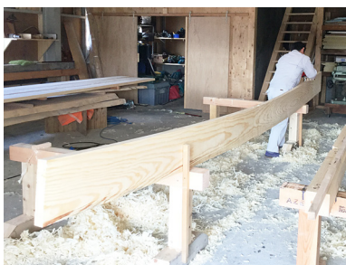
▲は『都建築』で現在建築中の建物。上方へ凸型に湾曲する「むくり屋根」を採用しており、▶が屋根で重要な「破風板」の加工風景。
